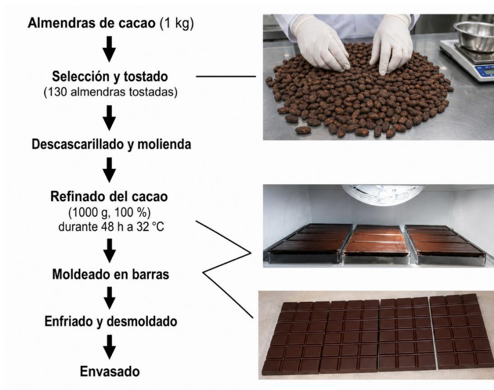
Figura 2. Diagrama del proceso de obtención de pasta de cacao al 100%.
